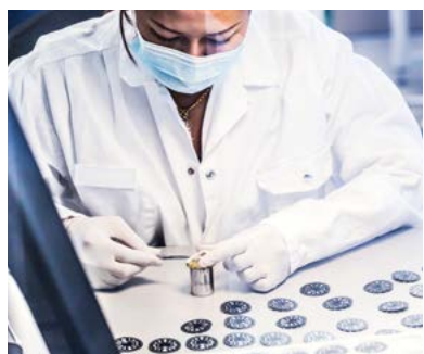
L'horloger applique la partie adhésive de la pièce estampée sur le cadran
