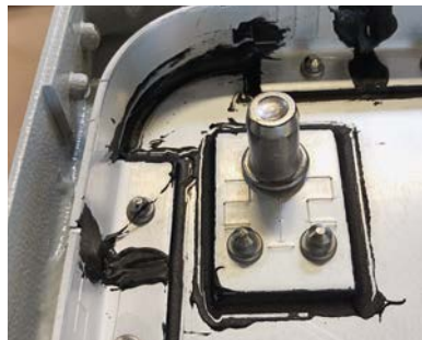
Après application, le mastic forme une fine peau à la surface dans les 4 heures, ce qui rend le produit résistant au délavage d'avant revêtement poudre.
