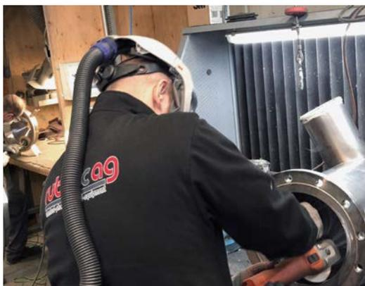
Le système respiratoire 3M Adflo protège l'opérateur lors du polissage effectué avec une meuleuse d'angle «Fein Compact»
