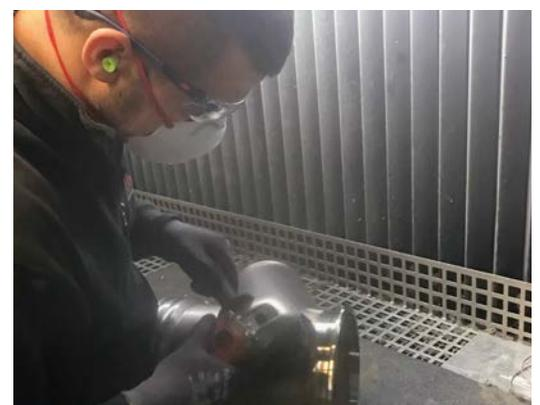
Protection maximale lors du polissage – lunettes, masque, bouchons d'oreilles et gants
