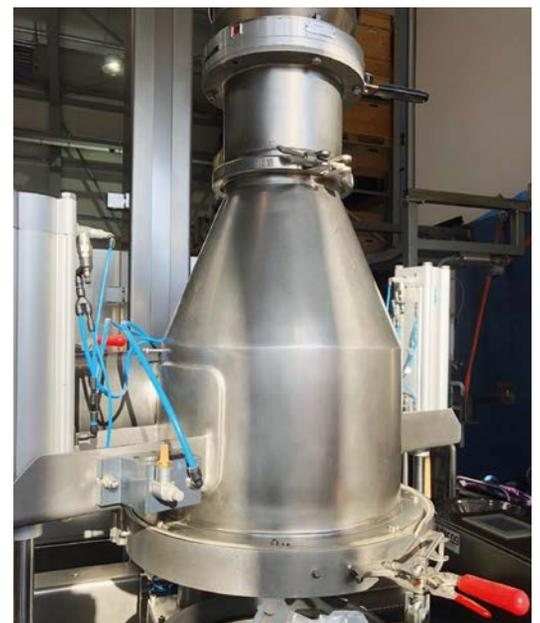
Cordons de soudure parfaitement rectifiés dans une installation de remplissage
