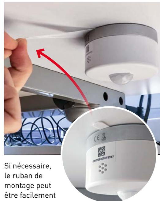
Si nécessaire, le ruban de montage peut être facilement retiré en le tirant simplement.
