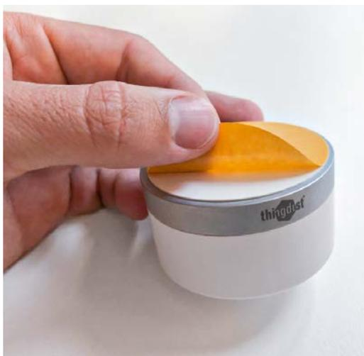
Le film de protection est retiré du ruban adhésif au niveau de la languette puis le capteur est collé au plafond ou sous le bureau.
