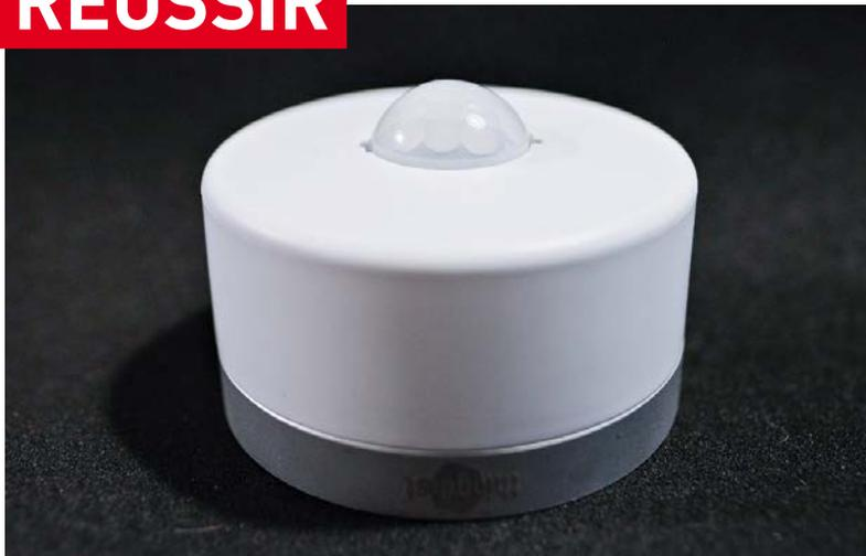
Les multi-capteurs sont placés sous les postes de travail ou au plafond des salles de réunion.
