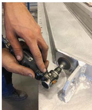
Un casque de sécurité, des protections auditives et des gants de **3M** protègent l'opérateur durant le meulage. Les **disques en fibre Klingspor** sont utilisés pour le ponçage fin des soudures et des surfaces.
