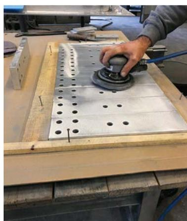
En ce qui concerne le ponçage fin, un **disque 3M 775L Cubitron II Hookit** est utilisé.
