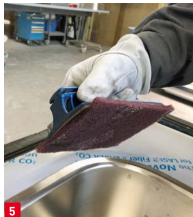
5 Le Scotch-Brite 3M CF-RL est utilisé pour affiner et finir l'acier inox afin qu'il brille de tous ses feux
