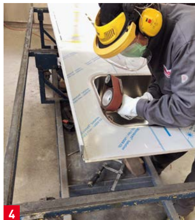
4 Si vous poncez, protégez-vous : protection combinée de l'ouïe et du visage (3M G500) et gants de 3M. Dans cette étape de travail, la surface est poncée longitudinalement
