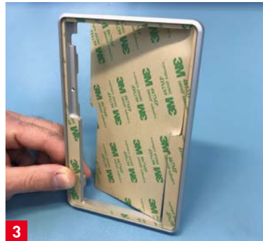
2 Im Anschluss wird das selbstklebende IBZ-Formstanzteil positioniert und das Trägerpapier unten weggezogen.
