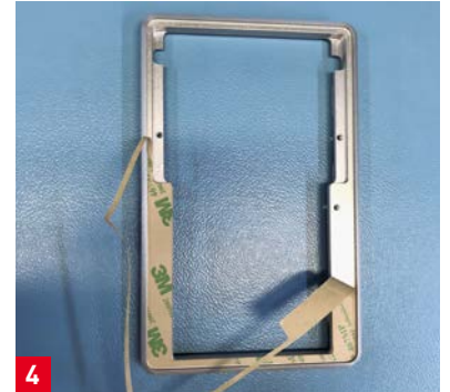
1 Der Aluminiumrahmen wird vor der Verklebung mit IBZ-Isopropylalkohol gereinigt.
