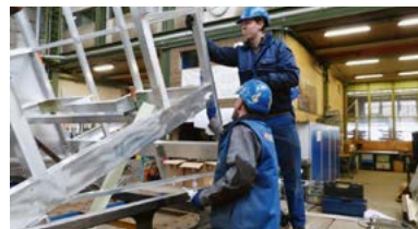
Nach der Reinigung mit dem 3M Oberflächenreiniger wird der 3M Primer aufgetragen
