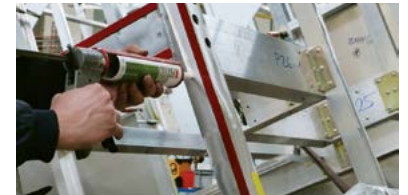
Die 3M Powerline Polymer Hybrid Kleb-/Dichtmasse wird neben dem Klebeband aufgetragen. Schutzfolie wird vom Klebeband abgezogen
