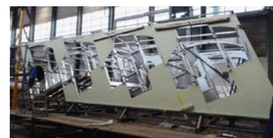
Les tôles de carrosserie sont collées sur le châssis
