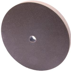
Das **R-Flex Rad** ist lieferbar in unterschiedlichen Kornarten und Bindeshärten und eignet sich dadurch sowohl zum Entgraten als auch zum Feinschleifen. Durch die elastische Bindung ist es profilierbar und für jede Werkstückform optimal.
