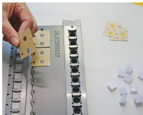
Stanzteil aus doppelseitigem Klebeband wird für die Verbindung des Tastenträgers (weiss) mit dem Messingteil verwendet. Die Registerstanzungen ermöglichen eine positionsgenaue Applikation.
