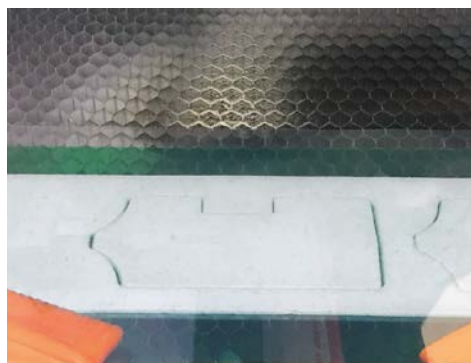
Einseitiges Extrem-Dichtband wird auf Rollen lasergeschnitten
