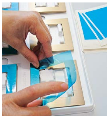
Oberflächenschutzfolie wird appliziert.
