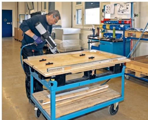
La préparation de la surface est une étape indispensable pour garantir une adhérence optimale. Les pièces à coller sont nettoyées avec de l'alcool isopropylique et poncées avec Scotch-Brite very fine avant le collage.
