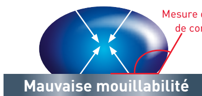
1. Surfaces à basse énergie (difficiles à coller)
