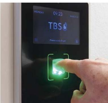
Grâce au Covid 19, le capteur 3D sans contact est plus demandé que jamais. En effet, avec les lecteurs d'empreintes digitales 2D, l'utilisateur doit placer son doigt directement sur le capteur biométrique !
