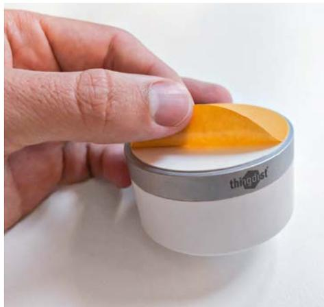
Le film de protection est retiré du ruban adhésif au niveau de la languette puis le capteur est collé au plafond ou sous le bureau.
