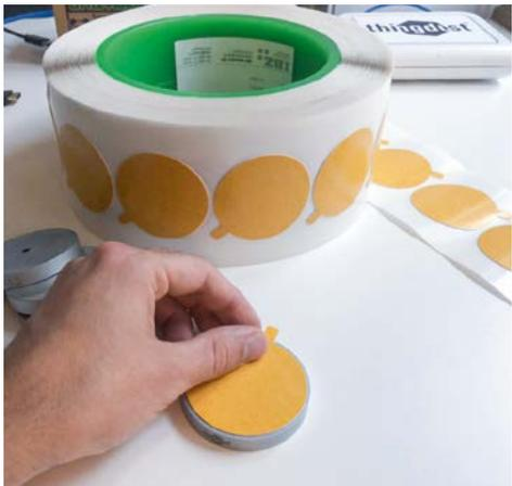
Le multi-capteur est équipé d'une pièce étampée d'IBZ en ruban adhésif d'assemblage amovible double face.
