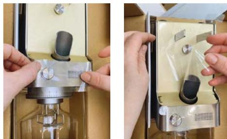
Avant l'emballage, un film de protection de surfaces est appliqué à différents endroits. Celui-ci est prédécoupé avec précision, à la forme et à la taille requises. Il permet de s'assurer que les appareils arrivent chez le client sans aucune rayure. Le film peut être retiré sans laisser de traces avant l'utilisation.
