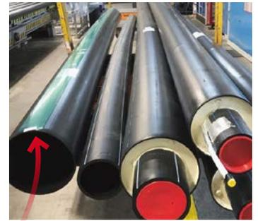
En cas de sciage du tube et afin d'éviter de tomber sur une des entretoises, les emplacements de celles-ci sont marqués sur le tube d'environ 6 mètres de long.
