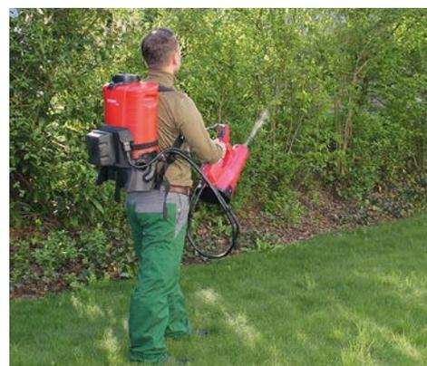
Grande efficacité sur la zone ciblée : Le flux d'air réglable et la pré pulvérisation pressurisée permettent d'atteindre de grandes portées de pulvérisation avec une perte minimale de produit en assurant un mouillage optimal et une très bonne pénétration au sein du feuillage ou de la végétation.
